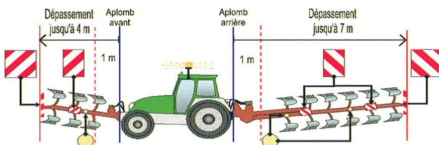
Pour les véhicules isolés dont la longueur dépasse 12 m et pour les ensembles de véhicules dont la longueur dépasse 18 m, j'utilise des catadioptres latéraux ou j'alterne les catadioptres et les feux de position latéraux.
